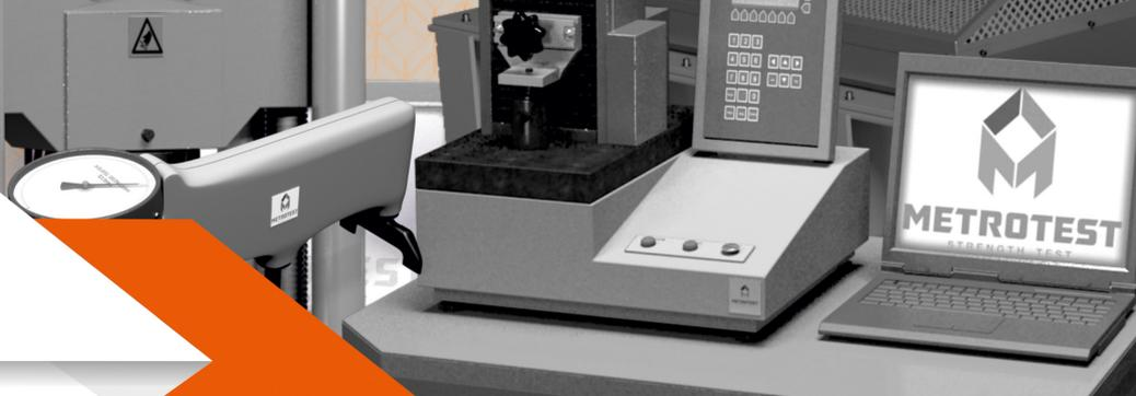
**Копры вертикальные типа КВ** предназначены для определения ударной прочности образцов при испытании материалов падающим грузом с максимальным запасом потенциальной энергии до 100 кДж в соответствие с ГОСТ 30456, API RP 5L3, EN 10274, ASTM E208, GB/T 6803, API5L3, ASTM E436, ASTM E604 и др.
